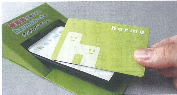
ハルモは交通システムや各種電子マネーで使われている非接触型ICカード技術
