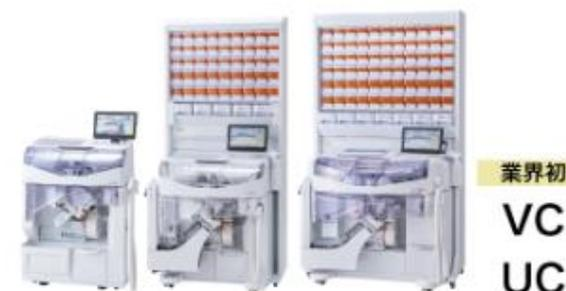
ヒーターローラー方式による強力なシール精度、ユヤマ独自のオープンメンテナンス設計、服薬コンプライアンスを多角的に支援。
