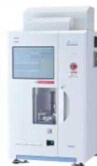
処方内容と紐づけたQRコード記載のラベルが自動発行されるので正しいサイズの投薬瓶に貼って投薬容器セット部に置くだけで自動分注がスタート。
